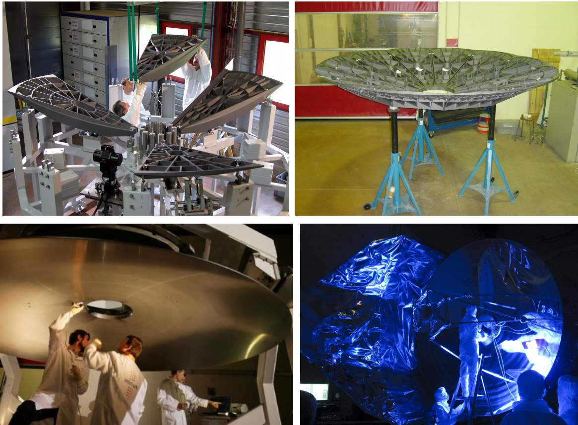
Fig. 41. En haut à gauche : mise en place des segments avant brasage. En haut à droite : structure du miroir en 12 pétales de SiC. En bas à gauche : vérification par ultra-sons des joints de brasure entre les segments. En bas à droite : inspection à Kourou du miroir avec des lampes UV.
